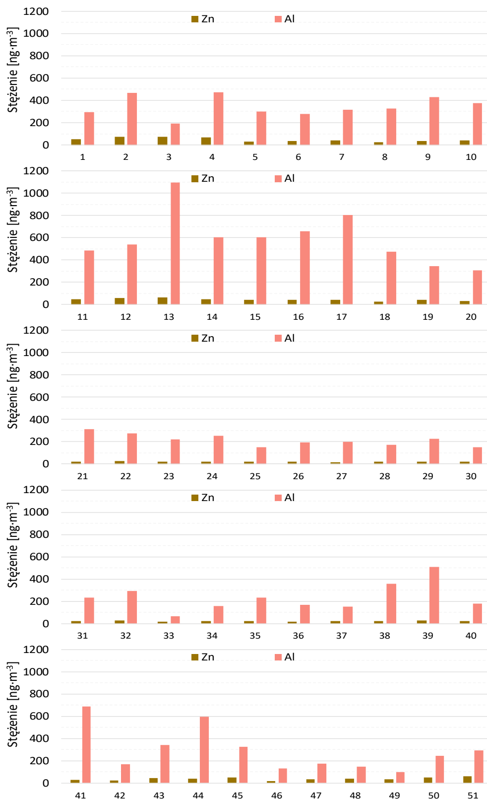
Rysunek 10. Stężenie cynku (Zn) i glinu (Al) [ng·m -3 ] w próbkach tygodniowych pyłu PM10 ze Skawiny (okres: 01.01–21.12.2020 r.)
