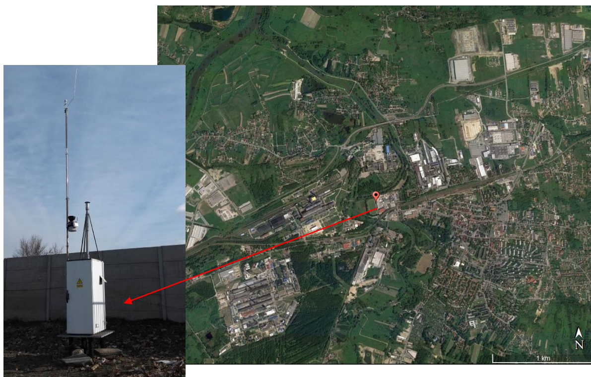
Rysunek 1. Lokalizacji stanowiska pomiarowego (N: 49.976647; E: 19.813679) oraz widok niskoprzepływowego pobornika \mu PNS LVS16 firmy MCZ
